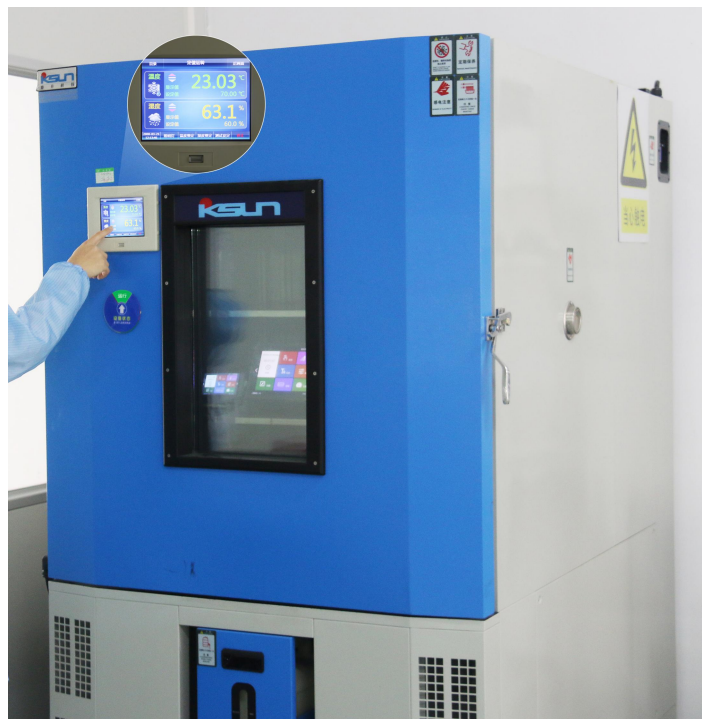
图 4-7 高低温老化测试图
