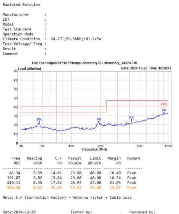
图 4-5 RE 测试水平方向
